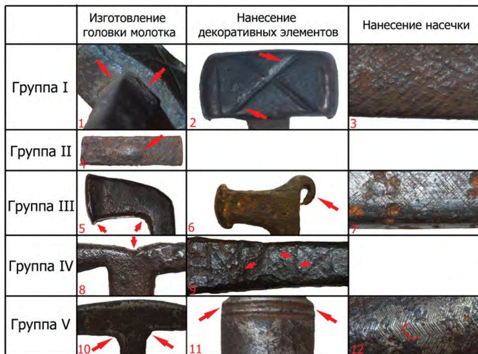
Рис. 5. Свидетельства технологических операций на инструментах: 1 – место стыка рукояти и головки молотка (группа I, ММ АЖ 10037/75); 2 – следы от работы зубилом при нанесении декоративных элементов (группа I, ММ АЖ 10037/75); 3 – насечка на полотне напильника (группа I, ММ АЖ 8221); 4 – расклёпанный конец рукояти (группа II, ММ АЖ 3413); 5 – головка молотка (группа III, экз. из частной коллекции); 6 – декоративная кованая петля (группа III, ММ АЖ 7840); 7 – насечка на полотне напильника (группа III, ММ АЖ 7838); 8 – место изгиба разрубленной рукояти (группа IV, экз. из частной коллекции); 9 – проделанные резцом канавки с выступами металла по краям (группа IV, экз. из частной коллекции); 10 – асимметрия в месте разгиба конца рукояти в головку молотка (группа V, ММ АЖ 7830); 11 – заглаженные абразивным инструментом прорубленные декоративные канавки (группа V, ММ АЖ 7830); 12 – зубчатая насечка на полотне напильника (группа V, ММ АЖ 7830)
